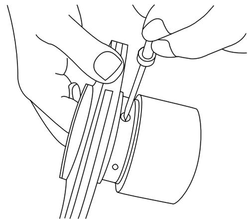
Si le tournevis ne peut pas être utilisé car l'empreinte du pion est abîmée utiliser une clef BTR en la passant par l'intérieur et tourner dans le sens anti-horaire. Le pion de blocage peut se casser si on tourne dans le mauvais sens.
