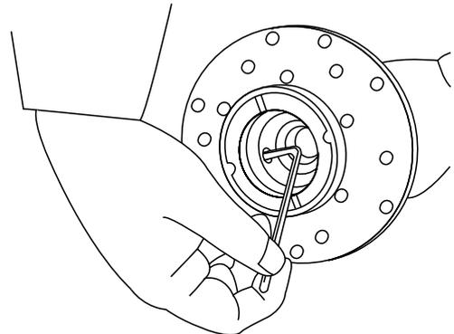
[2] Mettez la capsule magnétique et la turbine doucement dans le corps arrière. Faites attention à ne pas attirer sur la capsule magnétique des pièces ou des particules métalliques.
