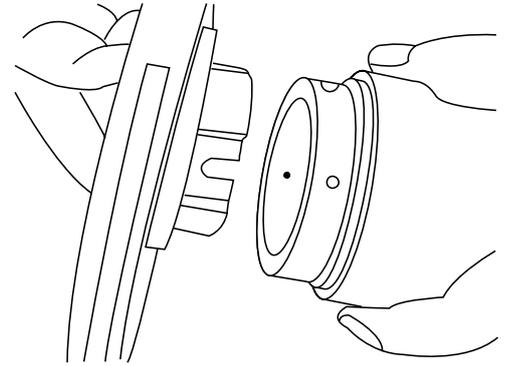
Une fois que la turbine est mise en place, insérez un pion de blocage dans le logement de l'intérieur vers l'extérieur. Le maintenir fermement avec le doigt et verrouillez-le à l'aide d'un petit tournevis en tournant de 90° dans le sens horaire. Mettre en place le deuxième pion de blocage de la même manière.
