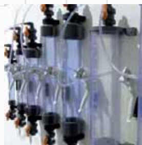
Module AMORÇAGE / ÉTALONNAGE : de 0,2 litre à 5,5 litres
